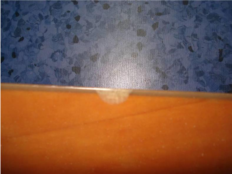
**Figure 2 – Trailing Edge Chip**
