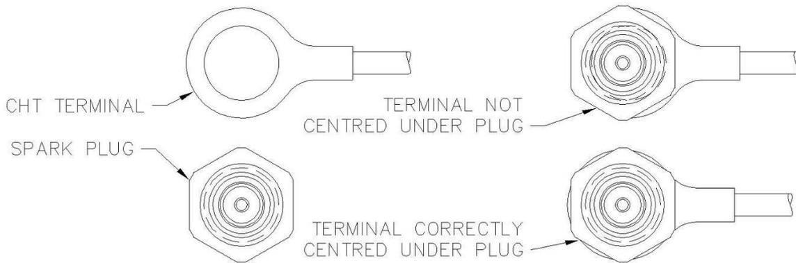
Figure 26. CHT Terminal Installation
